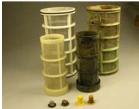
Intakte (links) und unbrauchbare (rechts) Filter im Applikationsgerät (Foto: G. Hipp)
